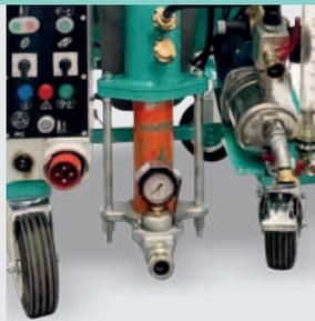
Flangia di mandata materiale in ghisa con misuratore di pressione. Connessione diretta per tubo DN35 F. Permette di estendere le tubazioni fino a 50 m con il minimo incremento delle pressioni di lavoro. La riduzione per applicare il tubo DN 25 è inclusa nell'equipaggiamento di serie.
