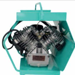
Compressore a pistoni C400230/50Hz 2,2 kW
