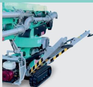
Carro semovente su cingoli allargabili, per una facile mobilità anche sui terreni più accidentati.
