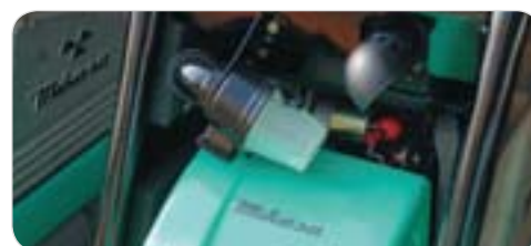
Doppio filtro aria Cyclone system (MVH 406DSC-430)
