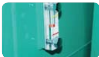
Indicatore idraulico livello olio
