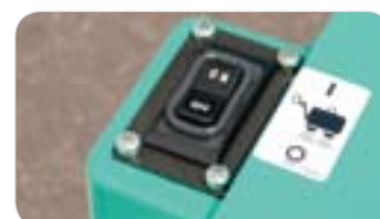
Interruttore di attivazione della frizione elettromagnetica per la vibrazione
